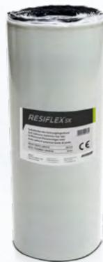
RESIFLEX® SK ist ein selbstklebendes, bitumenverträgliches Dehnfugenband auf Basis des Synthekautschuks EPDM und enthält in den äußeren Randbereichen eine Glaslegeeinlage. Innerhalb der Dehnungszone ist RESIFLEX® SK unarmiert (80 mm). Die Unterseite ist mit einer selbstklebenden, polymermodifizierten Bitumenschicht versehen, die durch eine abziehbare Trennfolie geschützt ist.
