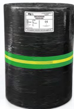
Leistungsstarke Drainagematte, für waagrechte und senkrechte Oberflächen, bestehend aus einem druckfesten Noppenkern aus PE-HD und einem thermisch behandelten Filtergeotextil an beiden Außenflächen. Abflussleistung geprüft nach ÖNORM EN ISO 12958 MD/CMD zwischen weichen Platten. Für extensive und intensive Begrünungen, Umkehrdächer sowie befahrene Dächer geeignet.
