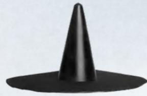
EPDM-Formteil zur Eichtung von überstülpbaren Dachdurchführungen mit rundem Querschnitt und mit Durchmessern von 5 bis 100 mm. Der Anschlusskragen besteht aus einem kreisförmigen Zuschnitt aus RESITRIX® mit einem Durchmesser von bis zu 50 cm.
